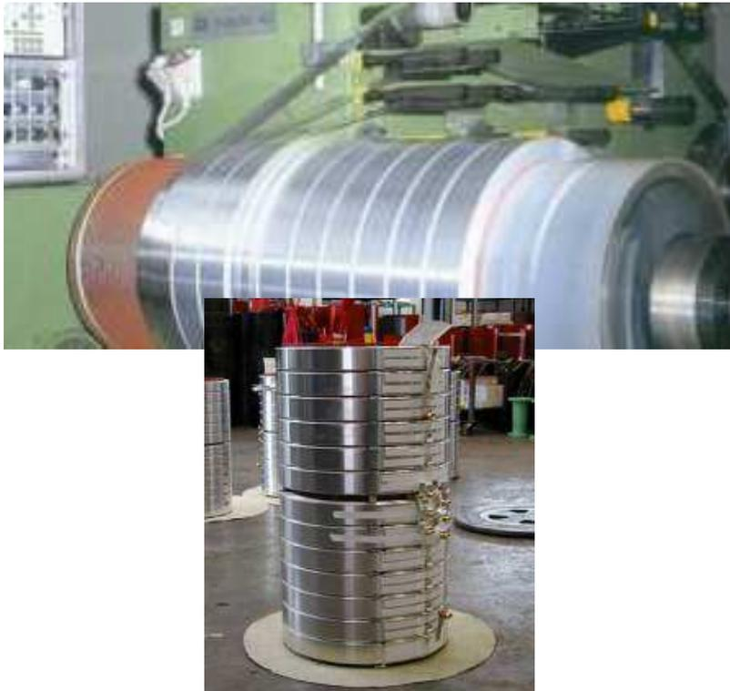
**Les enroulements HT** sont réalisés avec des bandes d'aluminium pour optimiser les caractéristiques thermiques. Un processus de soudure au gaz inerte assure la qualité. Les enroulements sont ensuite moulés sous vide dans la résine
