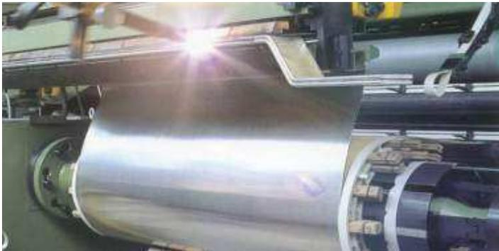
**Les enroulements** BT sont réalisés avec des bandes d'aluminium isolées. Le processus de soudure de la plage se fait au gaz inerte. Les enroulements sont imprégnés sous vide.
