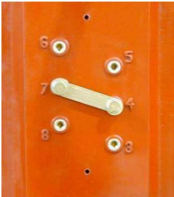
**5 Les plages de réglage** sur les enroulements HT permettent un ajustement pas à pas à la tension d'alimentation. La plage standard est +/- 2 x 2.5%
