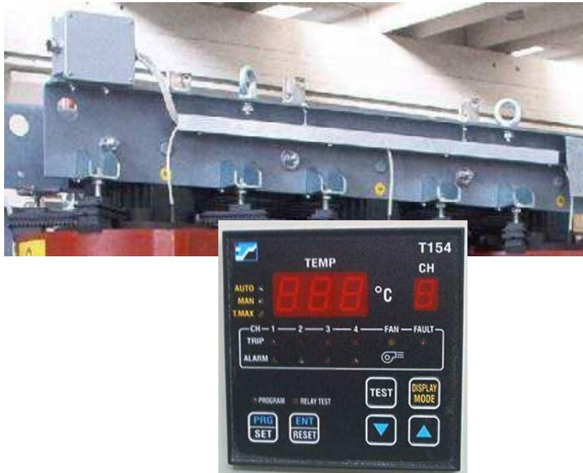
La mesure de la température de fonctionnement du transformateur est possible par des sondes PT100 ou PTC placées dans les enroulements BT. Les sondes sont reliées à un boîtier en aluminium.
