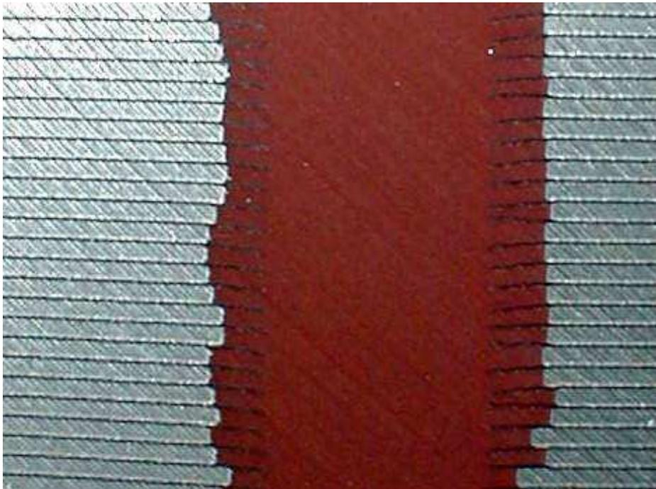
Les bandes matière isolants, e qui séparent les enroulements d'aluminium, sont moulées dans la résine. Seul un procédé de moulage sous vide s'assure que les espaces entre les feuilles d'isolation soient complètement remplies de résine, permettant un chiffre de décharge partiel très bas.
