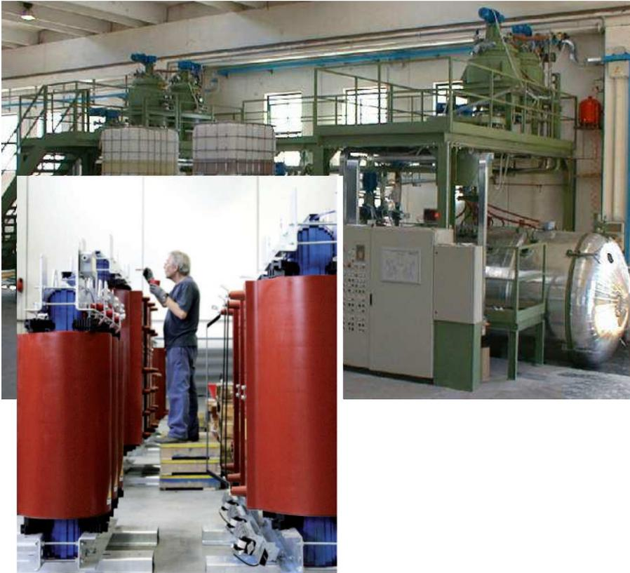
La résine est fabriquée et mixée sur place dans une unité de préparation commandée électroniquement. Elle est ensuite introduite dans les moules sous vide.
